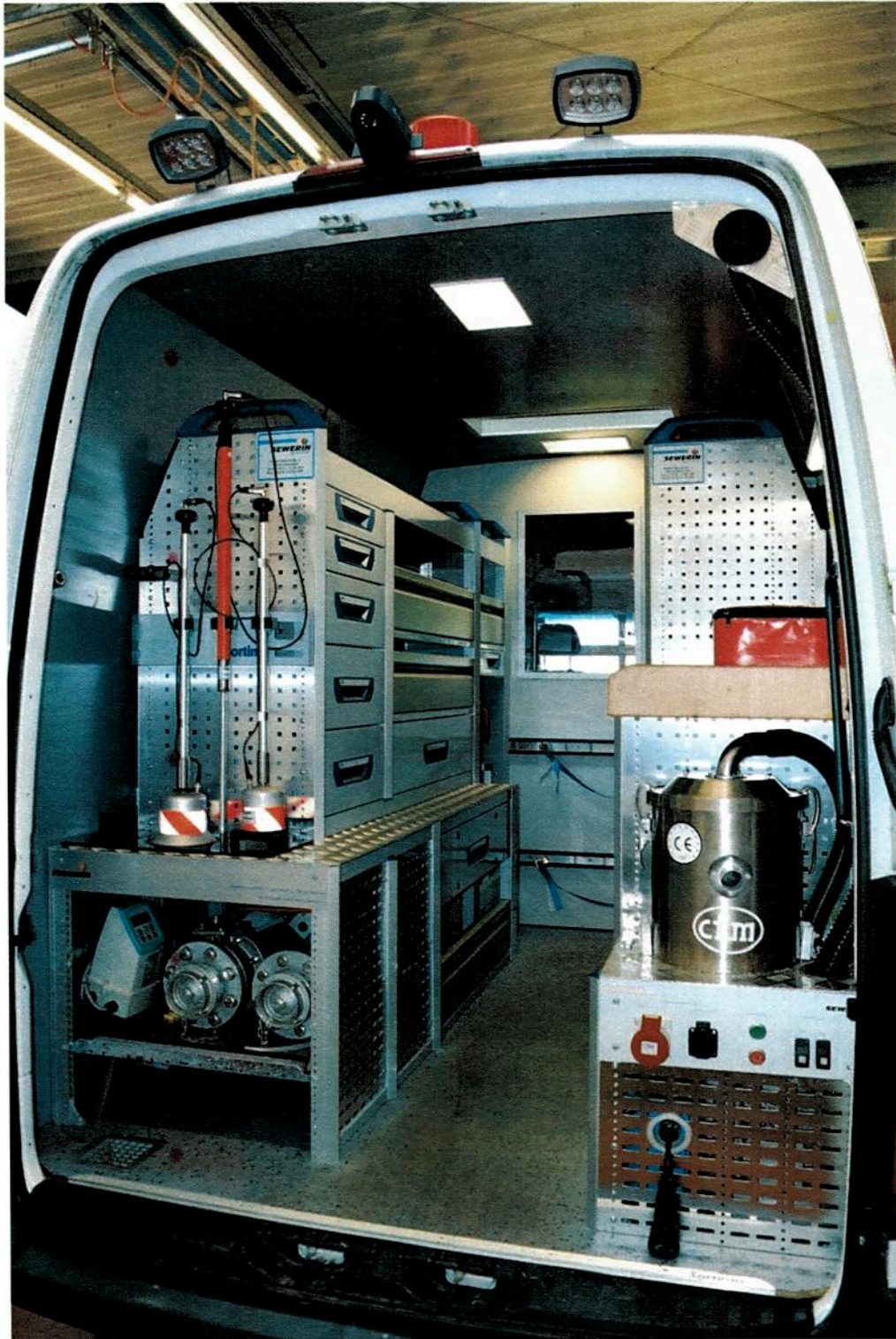
Figura 6: Personalización de vehículos para detección de fugas Fuente: UEP RANC-EE, 2018.
