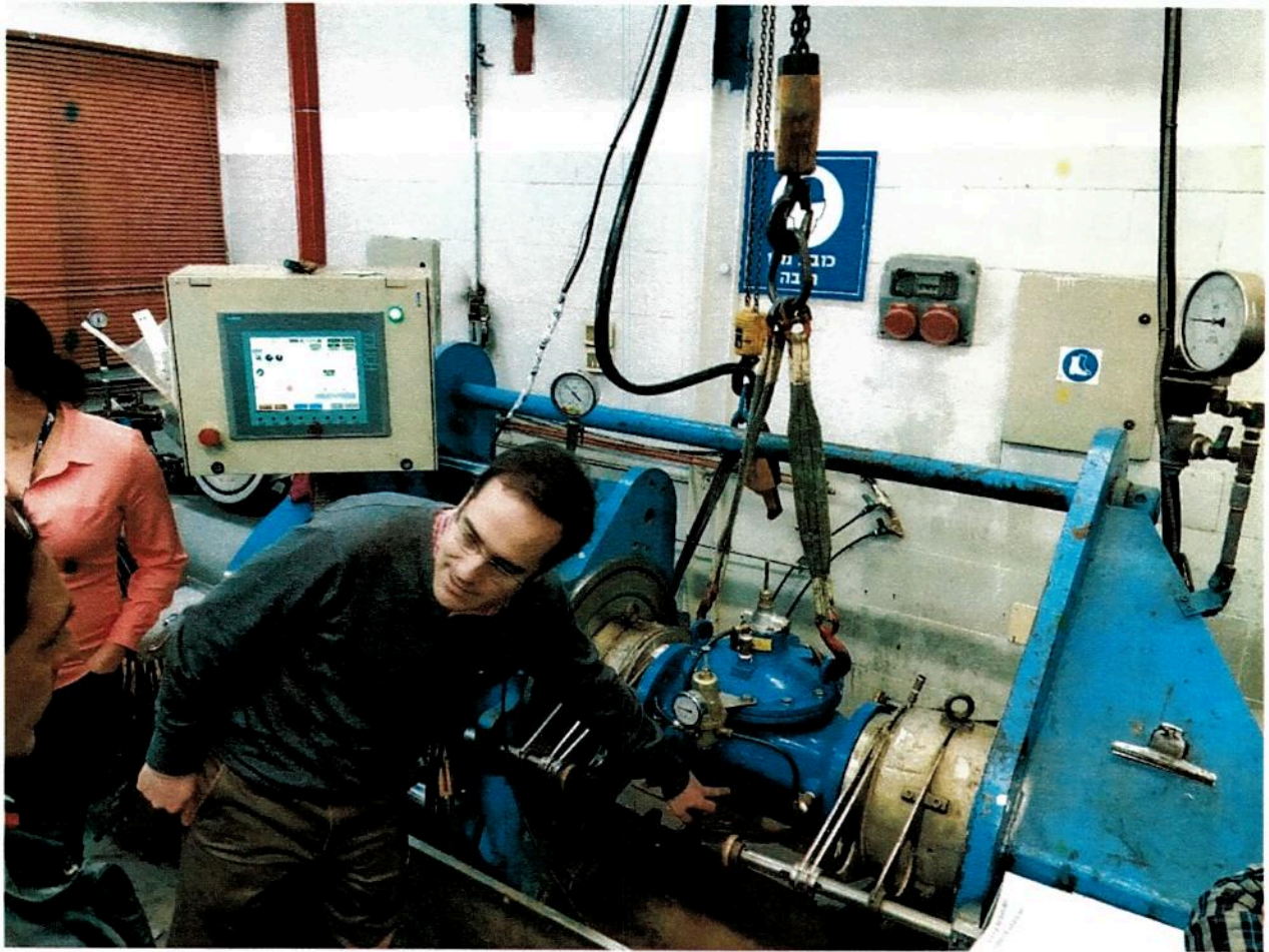
Figura 4: Pruebas de laboratorio a que se someten las válvulas de control hidráulico Fuente: UEP RANC-EE, 2018.
